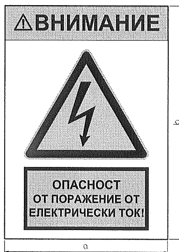
Фигура 2 - Табела „Внимание! Опасност от поражение от електрически ток!“
